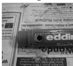
Abb. 3: Bohrung \varnothing 5mm
