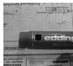
Abb. 4: Ecken mit Cutter entf.
